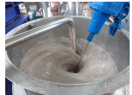
Pulpa cocida/tanque alimentación tricanter
