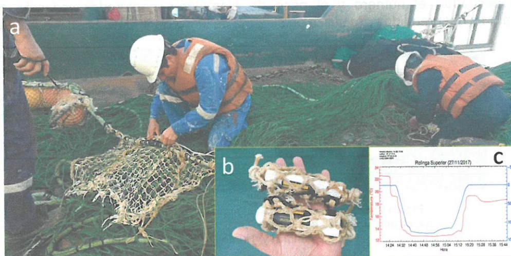
Figura 3. Red de arrastre pelágica (a), sensores NKE-MICREL (b) y la gráfica del post proceso (c). Cr. de Investigación del calamar gigante Cr.1711-12 BIC's. “José Olaya Balandra” y “Humboldt”.
