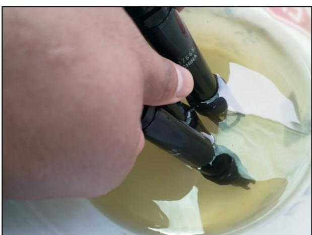
Sondas de Oxígeno disuelto, pH y Temperatura.
