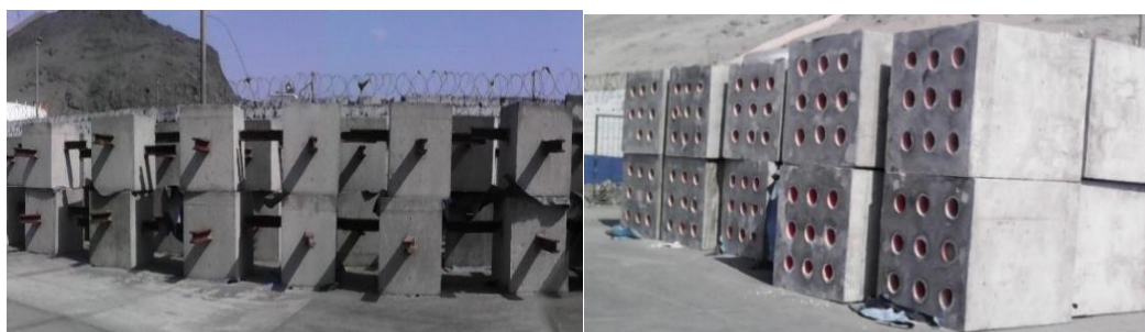
Figura N° 1.- Arrecifes artificiales de protección y de producción que fueron instalados frente al litoral de Magdalena de Cao, a una profundidad de aproximadamente 20 metros
