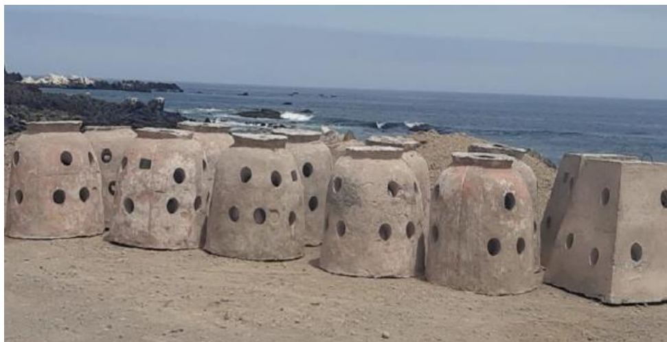
Figura N° 3.- Módulos alveolares de arrecifes artificiales de concreto armado tipos domo y pirámide trunca puestos en puerto Grau, Morro Sama
